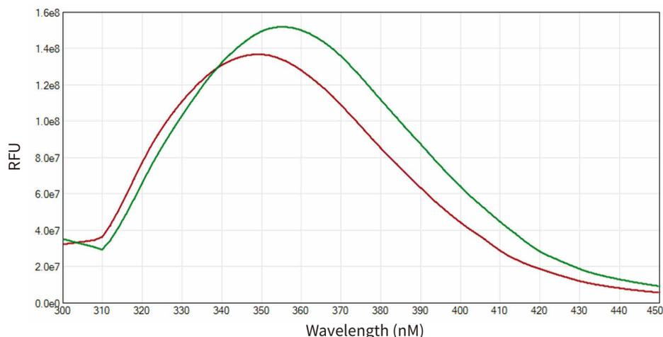
图3 溶解酶素变性后的波谱移位。溶菌酶素变性前(红)后(绿)发射波谱扫描结果如图所示。通过SoftMax Pro 软件预先设定的程序计算得到波峰位移为5.5nm。
