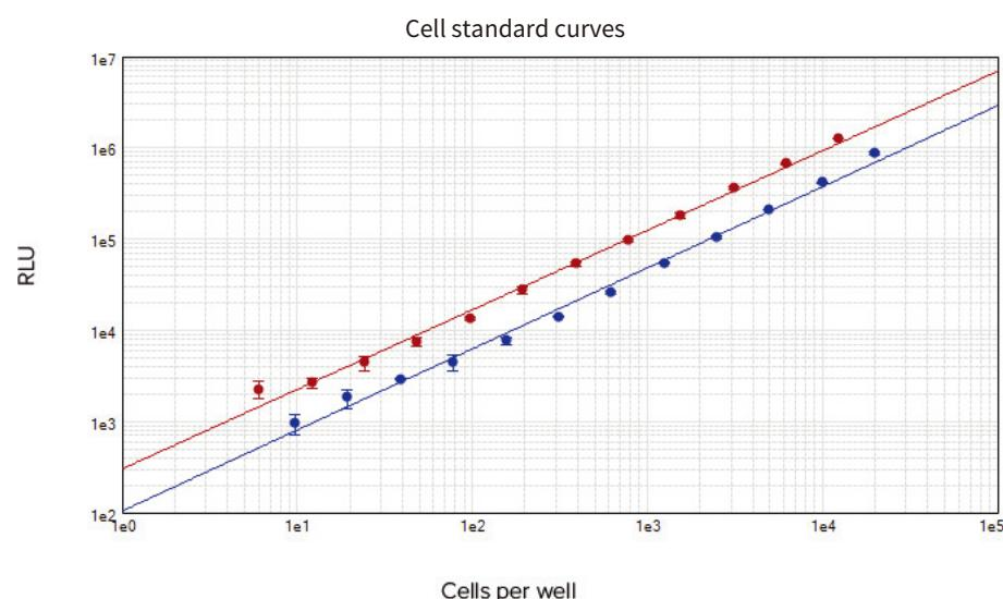
图一：图中分别是96孔板的标准曲线(蓝色圆圈)和384孔板的标准曲线(红色圆圈)，在每种类型的微孔板中，检测下限可至10个细胞每孔，两条曲线的标准方差值r<sup>2</sup> > 0.99
